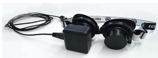
▲眼球運動解析システム(上)とその検査装置「ジャイロフレンツェルG96DA」(下)
